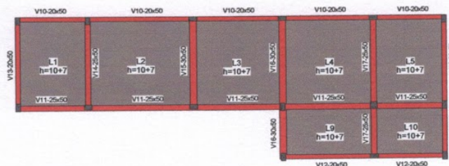
VIGAS SUPERIORES NÍVEL 2 ESC. 1:50
